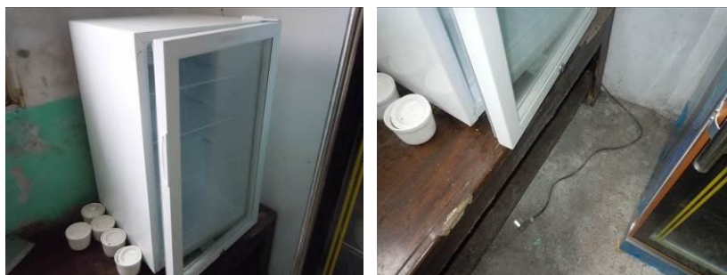
图 11 故障冰箱（右可见未接电源）
